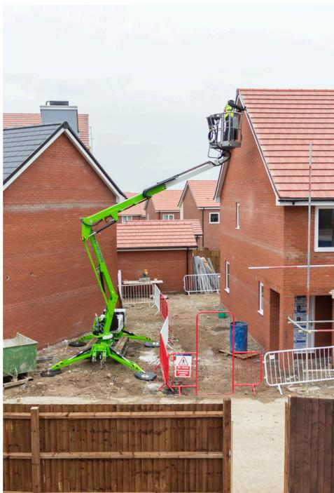
La TD120TN (conocida como elevador araña) ofrece una impresionante **envergadura de trabajo** sobre orugas con una tracción sobresaliente.
